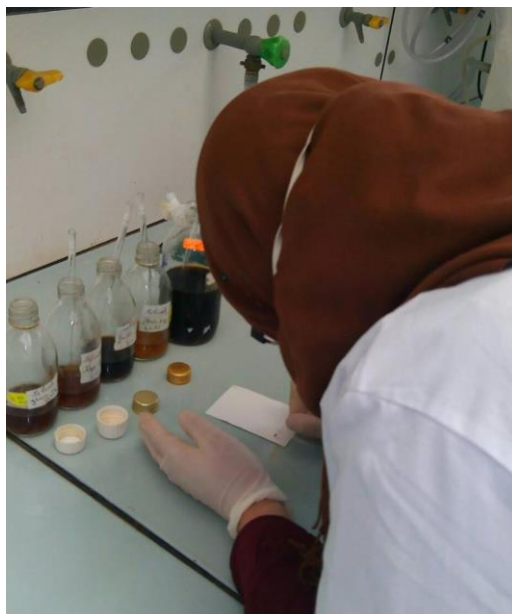
Figure 31 :photo du dépôt de la plaque CCM
